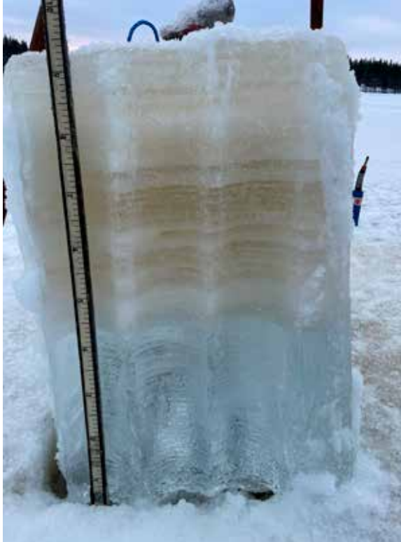
Ett av flera isprov. På det nästan 95 cm höga blocket syns isens olika lager tydligt. En klar, genomskinlig och jämn kärnis är starkast.
