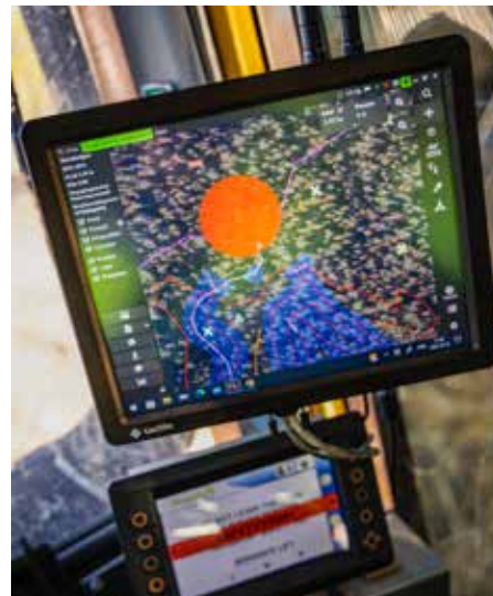
Varningssystemet i markberedaren består av ett blinkande ljus som är kopplat till kartan i maskindatorn.
