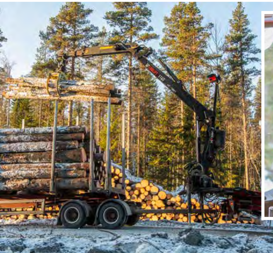
HiVision-kranen är utrustad med fyra kameror som är kopplade till VR-glasögonen. På så vis får föraren en live vidvinkelbild presenterad för sig.
